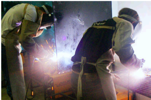
Exposição à Fumos metálicos causa a "febre dos fumos metálicos", além de outras doenças.
