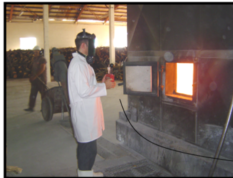
Medidor de Stress Térmico – instrumento para medir o calor no setor de trabalho.
