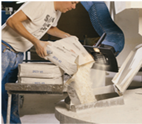
Exaustores para atividades expostas a produtos químicos diversos.
