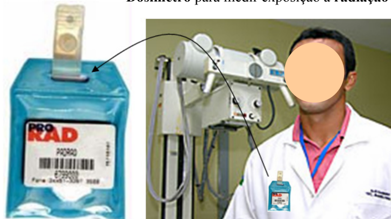
Dosímetro para medir exposição à radiação
